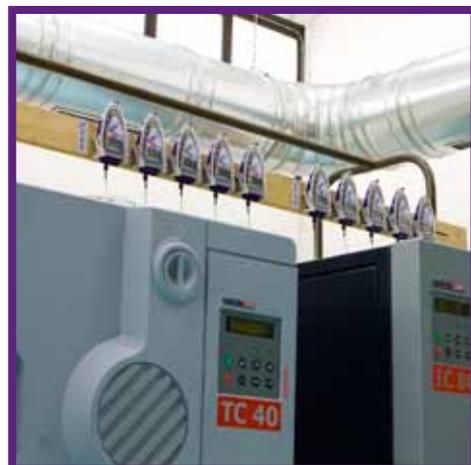
Controllo temperatura per mappatura stufe da laboratorio
